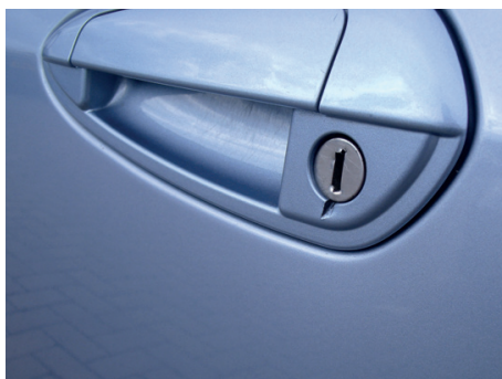
Schade door inbraak .
